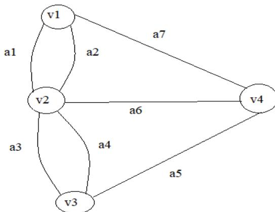
Aquí se muestra un grafo que modela el problema. Cada punto  $v_1$ ,  $v_2$ ,  $v_3$  o  $v_4$  representa un sector de la ciudad y cada uno de las líneas  $a$ , de 1 hasta 7, los diferentes puentes existentes.
