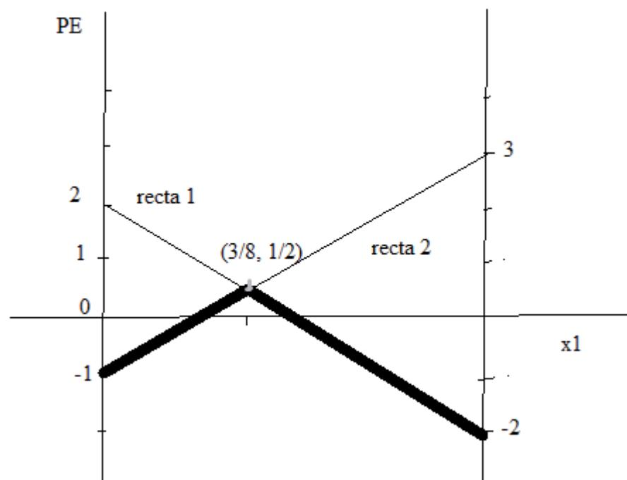
El óptimo se produce en la intersección de las rectas 1 y 2. Se tiene:
