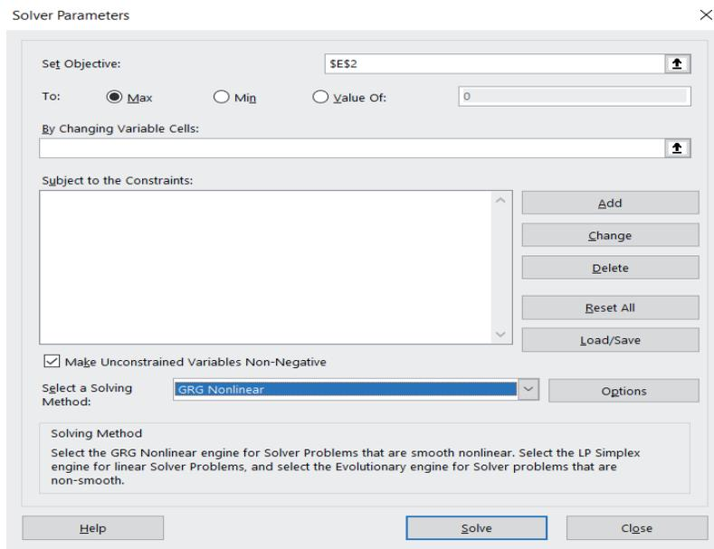
Aquí hay que ingresar los datos como la funcional objetivo, que tipo de operación deseamos hacer, maximizar o minimizar, donde estarán las variables a modificar o las restricciones que se tendrán en cuenta, así como el método utilizado para resolver. Al hacer todo correcto, nos dará como resultado los valores resultantes óptimos.
