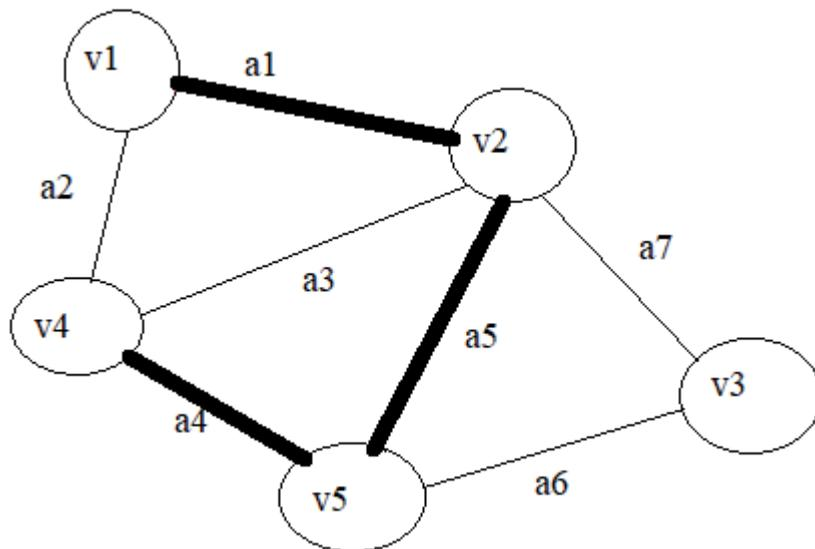
Una cadena cuyo vértice inicial coincide con su vértice final se denomina ciclo. El ciclo  $(v_1, a_1, v_2, a_5, v_5, a_4, v_4, a_2, v_1)$  se ve en la Gráfica 4.
