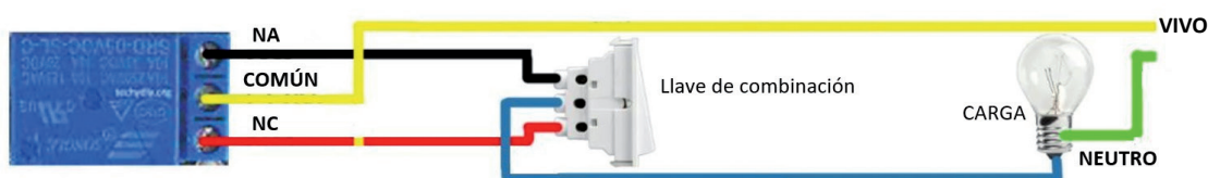
Figura 2 - Circuito de combinación entre la llave y el relé de la placa ESP-01s Relay.
