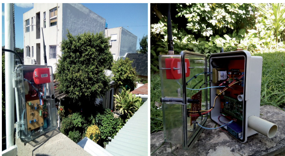
Figura N°2. Prototipo de sistema de monitoreo de calidad de aire y ruido ambiental.
