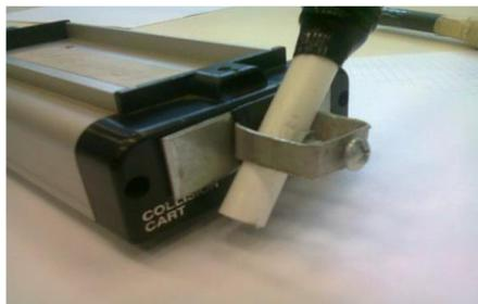
Figura 1 Dispositivo para trazos controlados.
