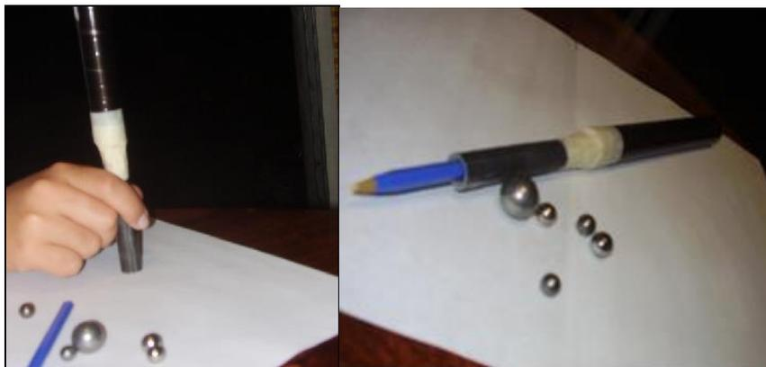
Figura 3. Dispositivo para realizar los trazos con fuerza controlada
