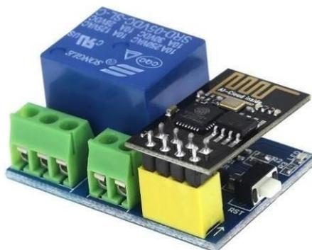
**Figura 1** - Placa ESP-01s Relay y módulo ESP-01s
