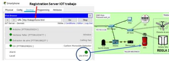
Figura 10. REGLA\_1 – Apertura ventana y encendido del extractor de aire para CO  $\geq$  20%
