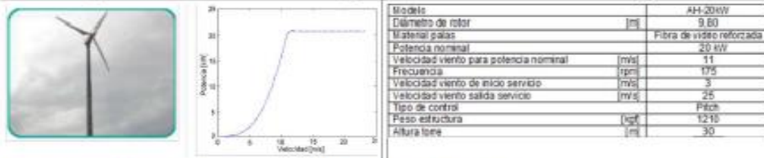
Figura 1: Aeroturbina ANE Modelo AH 20 kW y curva de potencia.
