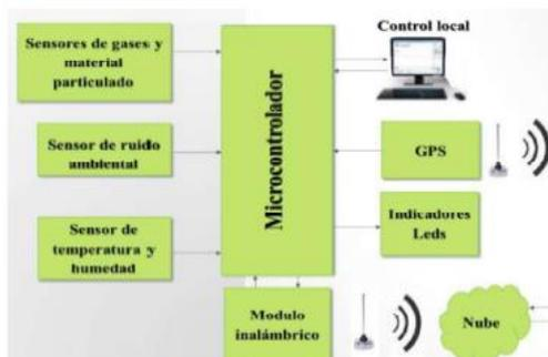
Figura N°1. Diagrama en bloques del sistema.
