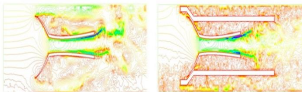
Fig. 4(a). Turbina sin montaje de doble carcasa
