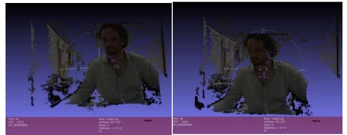
Fig. 8. Resultado de la nube de puntos a partir de la imagen estéreo
