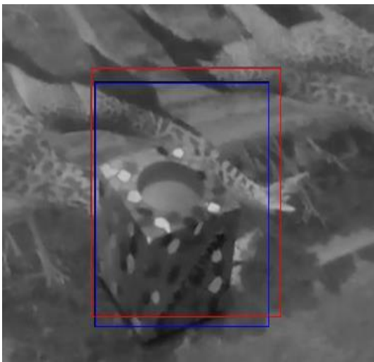
Fig. 13. Tomando un video donde se reconocía el cubo en la implementación en CPU se trató de reconocerlo. En rojo la detección de esta implementación y en azul de la anterior. Cabe destacar que se utilizaron diferentes plantillas
