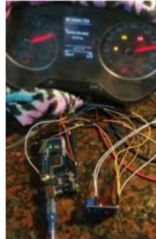
Figura 9. Pruebas de mensajes CAN
