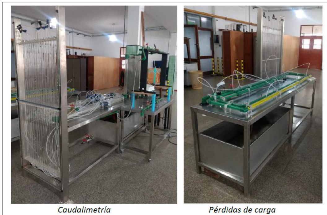
Imagen 4: Caudalimetría - Pérdidas de carga
