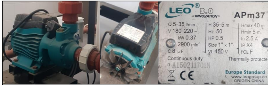
Figura N°2. Características de la bomba
