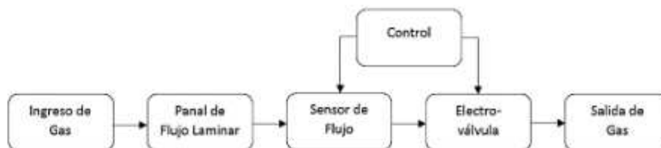
Figura 1. Diagrama en bloques del controlador de flujo
