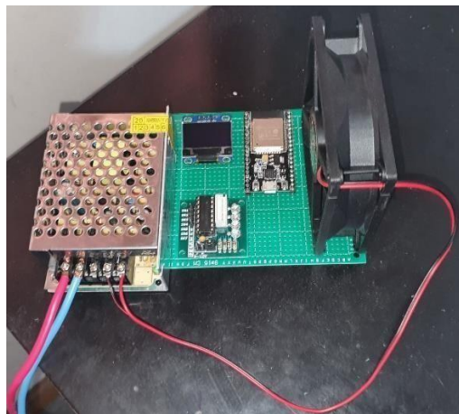
Figura 3 - Dispositivo que simula un electroventilador en un rango de temperatura ( 85\text{ }^{\circ}\text{C} < \text{temp} < 95\text{ }^{\circ}\text{C} )
