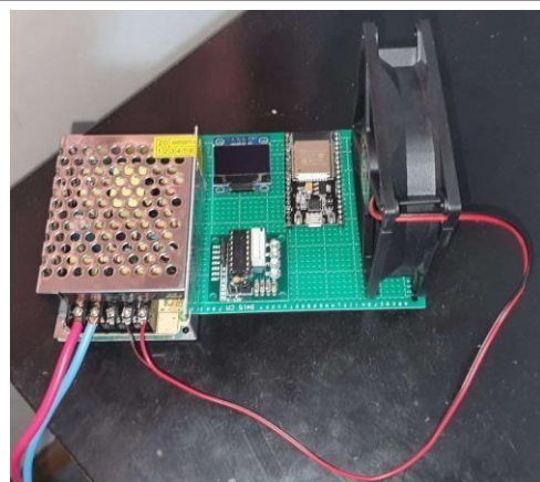
FIGURA 19. Dispositivo que simula un electroventilador en un rango de temperatura (85 °C <temp <95 °C)
