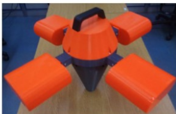
Fig. 3. Estructura mecánica de la miniboya.
