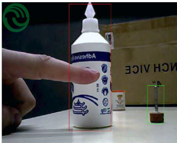
Figura 3: Detección de un envase de adhesivo vinílico con una pequeña oclusión y una piedra de desgaste.
