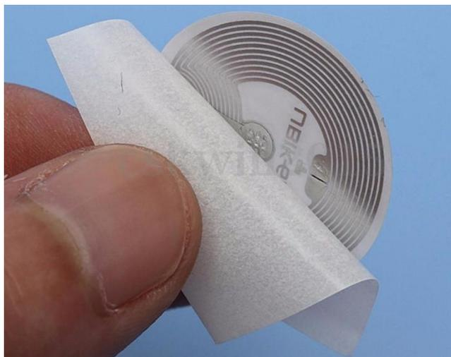
Figura 3. Etiqueta autoadhesiva RFID/NFC.
