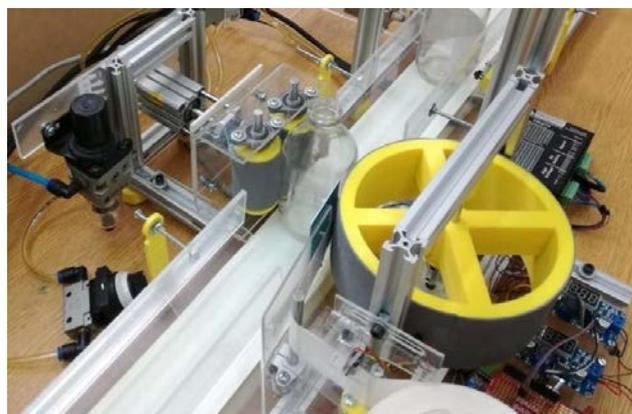
Figura 1. Sistema de etiquetado.
