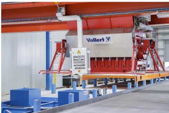
**Figura 22.** Las torres de estanterías aisladas y calefaccionadas de la cámara de curado son controladas por la grúa apiladora<sup>86</sup>
