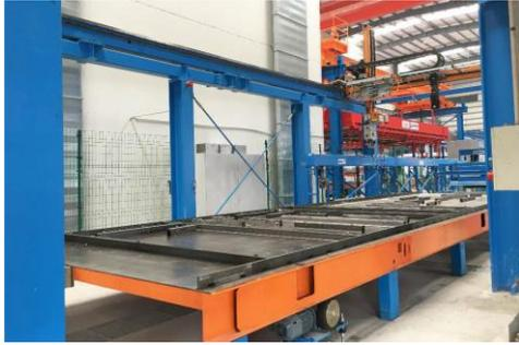
**Figura 20.** Introducción precisa del hormigón a través de un moderno distribuidor de hormigón automático Smart Cast<sup>84</sup>
