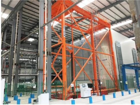
**Figura 23.** Equipo de volteo de bandejas Vario Turn altamente moderno y guiado por eltecho para la producción de muros dobles<sup>34</sup>
