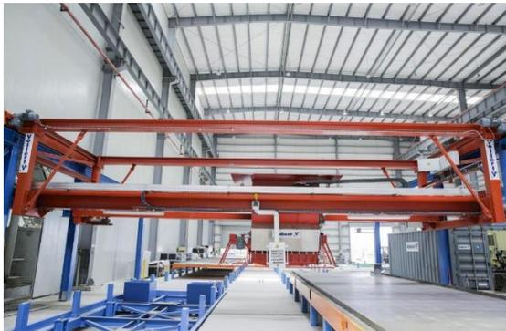
**Figura 21.** El sistema de control de la producción bajo el sistema MES genera un programa de desplazamiento óptimo para el siguiente proceso de hormigonado<sup>85</sup>
