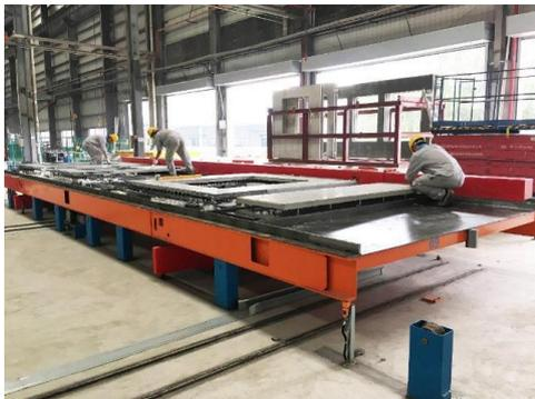
El poder asegurar la calidad es de gran importancia para la empresa, se ve como trabajadores ultiman detalles antes del llenado con hormigón de la cara externa de una pared de diez metros de largo, donde se observan los vanos ya marcados además de los revestimientos con las aislaciones interiores. Ese panel luego se montará con grúa en obra<sup>87</sup>.
