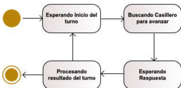
Figura 13. Diagrama de estado del ciclo de ejecución del video juego
