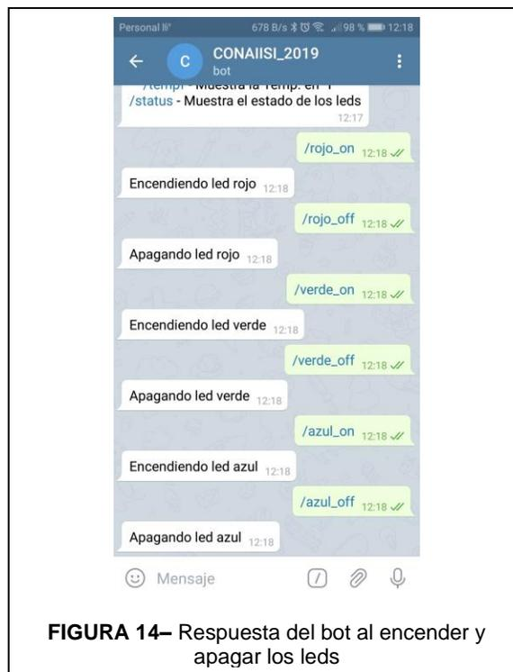
FIGURA 14– Respuesta del bot al encender y apagar los leds
