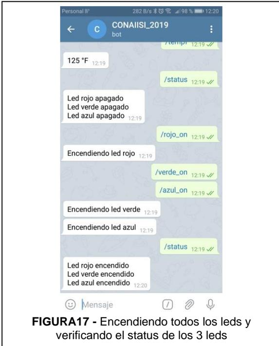
**FIGURA17** - Encendiendo todos los leds y verificando el status de los 3 leds
