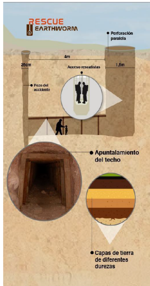
Figura 13. Rescate mediante pozo paralelo
