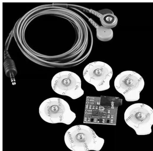
Figura 11. Modulo sensor electro muscular EMG V3, junto con sus conectores y electrodos.
