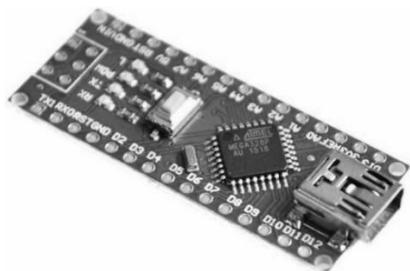
Figura 9. Arduino Nano Atmega328 Ch340.
