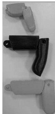
**Figura 7. De margen inferior a superior, versión I, II y III de un dedo no pulgar, ángulo de flexión, vista lateral.**
