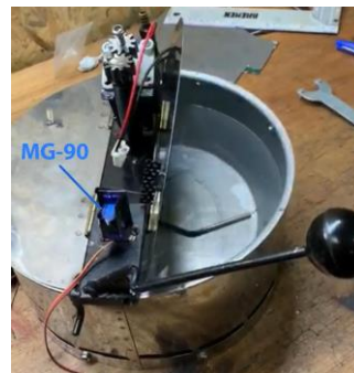
Figura 6: Apertura y cierre de tapa con servo MG-90
