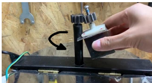
Figura 7: Rotación de paletas con motor
