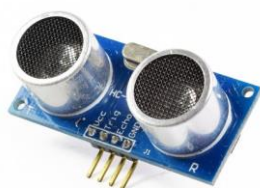
Figura 9: Sensor de distancia ultrasónico HC-SR04
