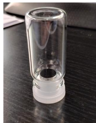
Figura 1. Stub de aluminio 12 mm de diámetro con cinta de carbono de doble adherencia. El mismo está depositado en un recipiente listo para hacer una toma de muestra de GSR y mantenerlo preservado después de la toma.
