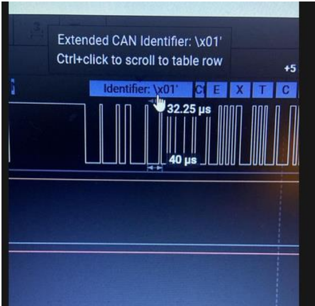
Figura 3: Trama CAN extendda.
