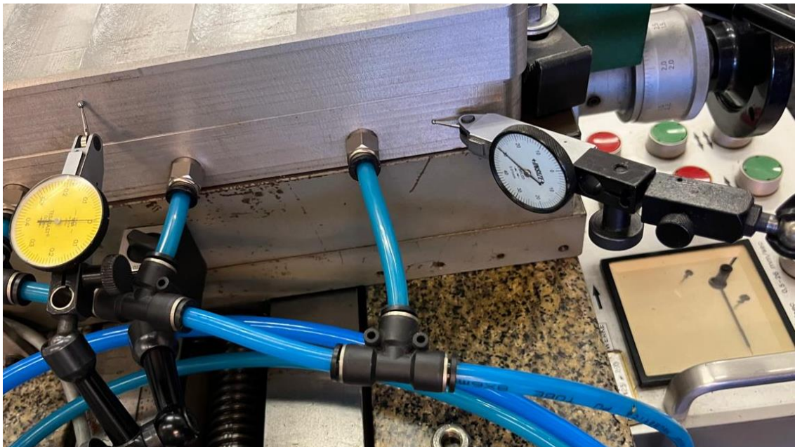
Fig5. Palpadores milésimales para detectar desplazamientos de la mesa de vacío y la placa a mecanizar.
