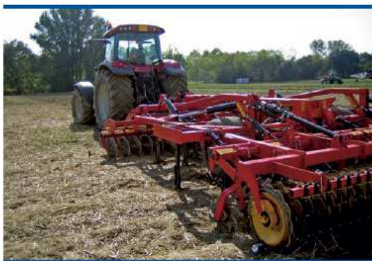
Figura Nº1.6–Equipo combinado de siembra.
