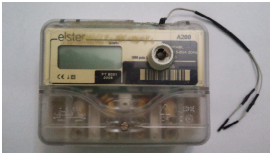
Figura N°7.1- Implementación de led indicador.
