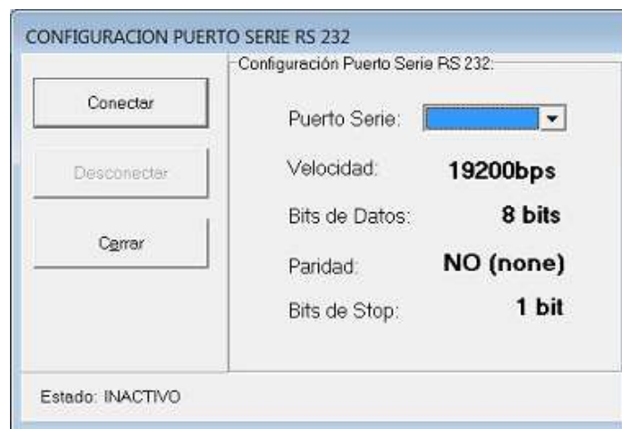
Figura N°5.31 – Configuración Puerto Serie RS232.
