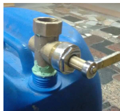
Figura N°9.14 - Salida de BIOGAS
