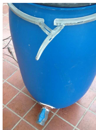
Figura N° 9.15 - Abrazadera que ajusta la tapa.
