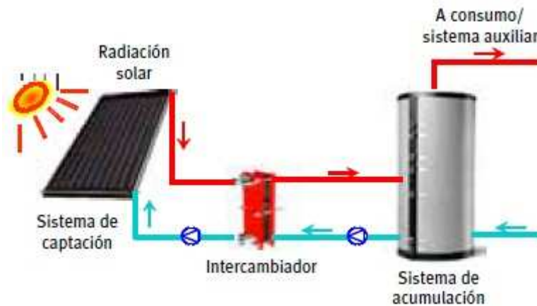
Figura N°1.15 – Sistemas de calefacción
