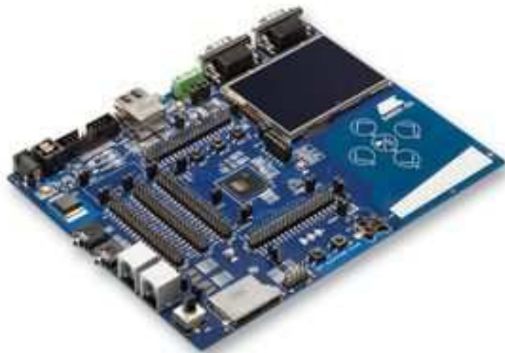
Figura N°4.1- Kit Atmel ATSAM3X-EK
