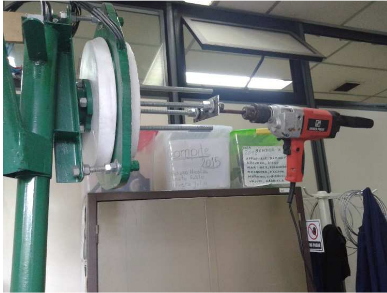
Figura 10.17 - Acople de taladro y generador
