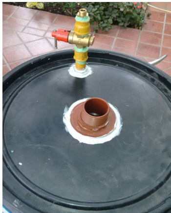
Figura N°9.18 - Entrada de materia prima y BIOGAS
