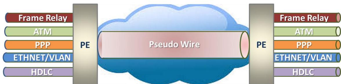
Fig. 9. Modelo de transporte en VPWS
