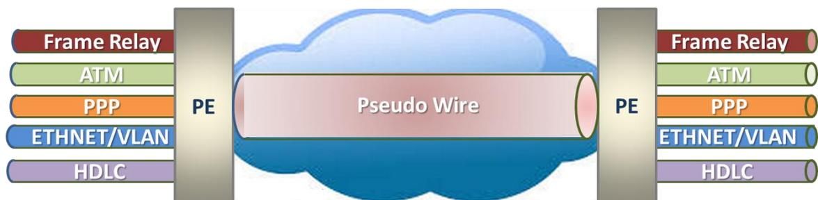
Figura 23: Modelo de transporte VPWS
