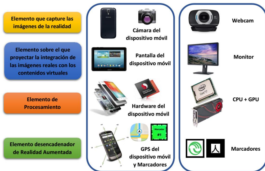
Fig. 1. Elementos básicos de Realidad Aumentada en dispositivos móviles y computadoras.
