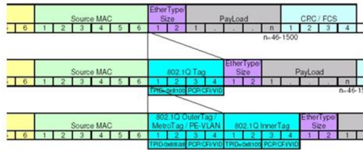
Fig. 6. Doble TAG de VLAN (802.1ad)
