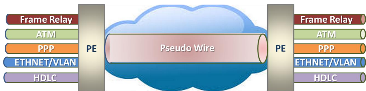
Fig. 9. Modelo de transporte en VPWS
