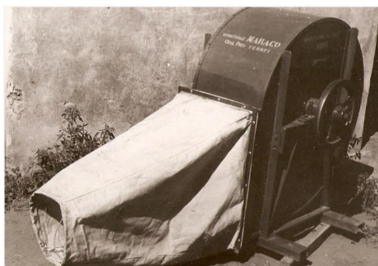
Ventilador de silos
