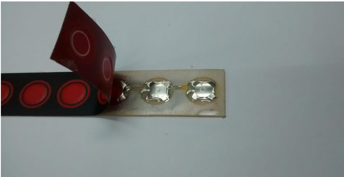
Figura 8.- Grupo de sensores sin la cubierta superior de policarbonato
