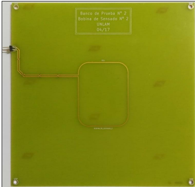
Figura N°4.87. Impreso Bobina de Sensado N° 2a y 2b - Imagen Capa TOP
