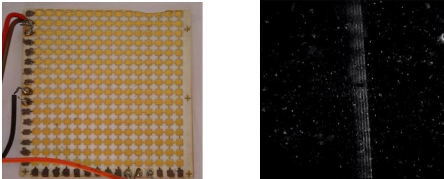
Figura 10: a) Matriz bidimensional de transductores PZT. b) Frente de onda emitido por una línea del transductor bidimensional.
