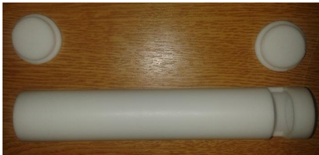
Figura 7 – Bastidor del conjunto sensor
