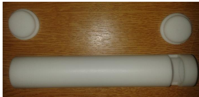
Figura 9 – Bastidor del conjunto sensor
