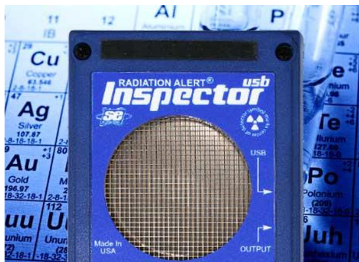
Figura N°20. Área del elemento sensor del Inspector EXP.
