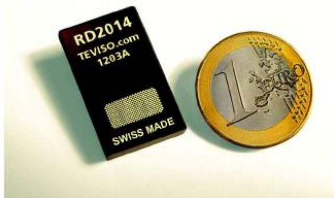
Figura N°23. Sensor de radiación TEVISO RD2014.
