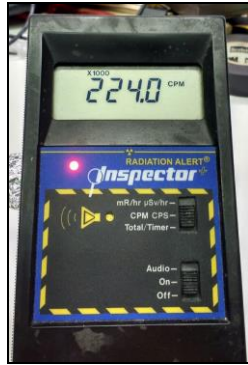
Figura N°18. SEI Inspector EXP.
