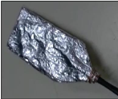
Fig.8. Circuito detector blindado.
